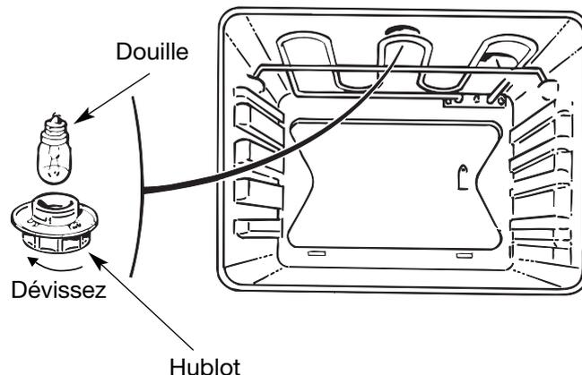
*Remarque : pour dévisser le hublot et la lampe, utiliser un gant de caoutchouc qui facilitera le démontage.*
