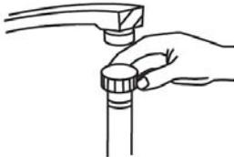
Vissez le connecteur droit du tuyau d'arrivée au robinet et serrez fermement; les rondelles doivent impérativement être bien en place à chaque extrémité du tuyau.
