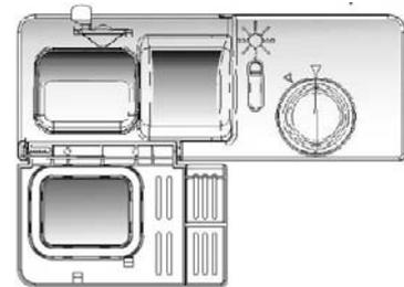
Les distributeurs de détergent et de liquide de rinçage sont situés du côté intérieur de la porte: le **distributeur de détergent** à gauche et le **distributeur de liquide de rinçage** à droite.
