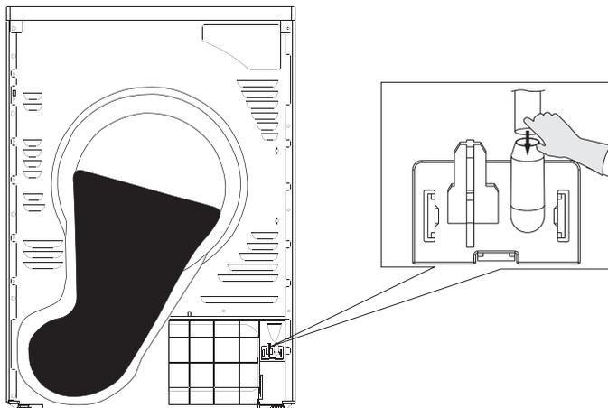
2. Insérez une extrémité du tuyau d'évacuation fourni dans le connecteur de tuyau.
