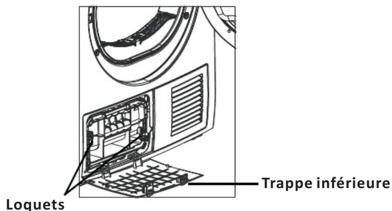
3.Retirez les peluches, les fibres et les effilochages de coton à la main, et si nécessaire nettoyez le condenseur sous l'eau courante puis séchez-le soigneusement.
