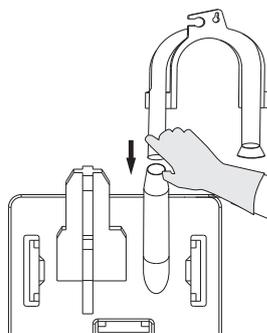
3. Placez et fixez l'autre extrémité du tuyau d'évacuation à proximité d'un lavabo à l'aide d'un raccord en U.
